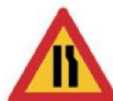
(Κ - 6β) Επικίνδυνη στένωση οδοστρώ- ματος στην δεξιά πλευρά.
