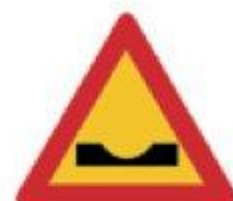
(Κ - 11) Επικίνδυνο κάθετο ρεϊθρο (αυλάκι) ή απότομη κοίλη αλλαγή της κατά μήκος κλίσης της οδού.
